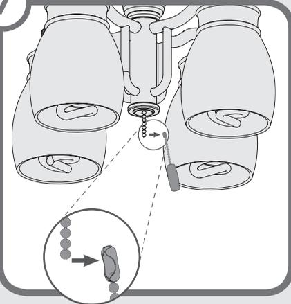
**Instalación del pendiente de cadena** - Conecte el pendiente de cadena al extremo de la cadena corta que sale de la caja del interruptor y del juego de luz.
