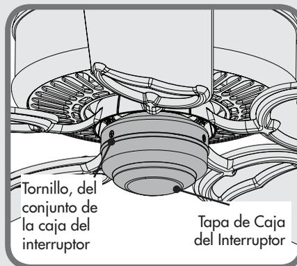
Si la tapa de la caja del interruptor de su ventilador se parece a ésta, quite toda la caja del interruptor; para ello deberá quitar los tornillos de la caja del interruptor con un destornillador estrella (Phillips). Quite los dos tornillos de la tapa desde el interior de la caja del interruptor. Reinstale la caja del interruptor. Apriete los tornillos de la caja del interruptor. A continuación siga las instrucciones de **MONTAJE TIPO A** de las páginas 4-5.
