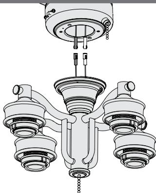
Use los conectores de pin individual para conectar el cable negro o azul del ventilador con el cable negro del juego de luz. Conecte el cable blanco del ventilador al cable blanco del juego de luz.
