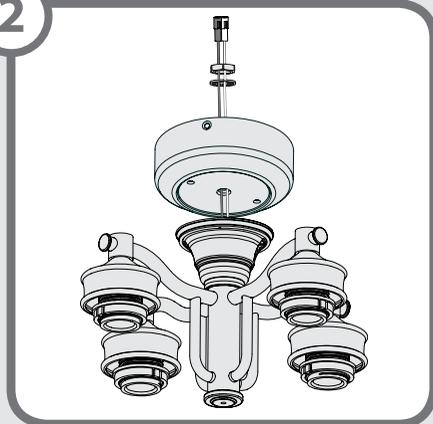
Pase los cables a través del orificio central de la caja del interruptor, la arandela y la tuerca.
