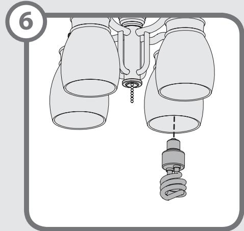
**Instalación de la bombilla** - Instale una bombilla en cada portalámparas. De ser necesario, reemplace las bombillas por bombillas del mismo tipo y voltaje.
