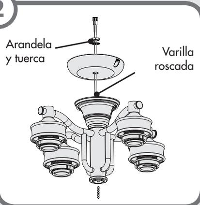
Pase los cables a través de la tapa de la caja del interruptor, de la arandela y de la tuerca. A continuación instale la tapa de la caja del interruptor haciéndola girar en sentido horario en la varilla roscada. Instale la arandela y la tuerca en la varilla roscada y apriete firmemente.
