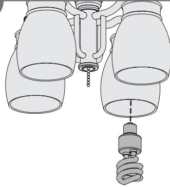
**Instalación de la bombilla** - Instale una bombilla en cada portalámparas. De ser necesario, reemplace las bombillas por bombillas del mismo tipo y voltaje.
