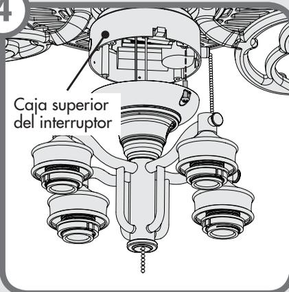
Levante el conjunto del juego de luz de modo que los orificios de los tornillos situados en la caja inferior del interruptor queden alineados con los orificios situados en la caja superior del interruptor. Instale los tornillos de la caja del interruptor y apriételos firmemente.
