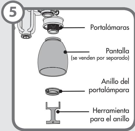
**Instalación de las pantallas** - Quite los anillos de los portalámparas. Instale cada pantalla en un portalámparas. Para instalar los anillos en los portalámparas, gírelos en sentido horario mediante la herramienta para anillos.
