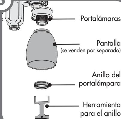
**Instalación de las pantallas** - Quite los anillos de los portalámparas. Instale cada pantalla en un portalámparas. Para instalar los anillos en los portalámparas, gírelos en sentido horario mediante la herramienta para anillos.
