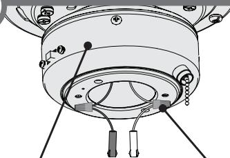
Si su ventilador no posee conectores de pines en los cables provenientes de la caja del interruptor, instale el manajo de cables proporcionado. Utilice los conectores de cables proporcionados para conectar el cable blanco del ventilador con el cable blanco del manajo de cables y conecte el cable negro o azul del ventilador con el cable negro del manajo de cables.
