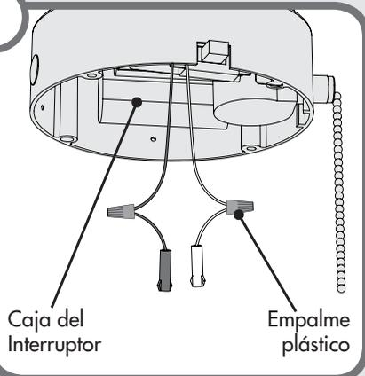
Si su ventilador no posee conectores de pines en los cables provenientes de la caja del interruptor, instale un manajo de cables proporcionado. Utilice los conectores de cables proporcionados para conectar el cable blanco del ventilador con el cable blanco del manajo de cables y conecte el cable negro o azul del ventilador con el cable negro del manajo de cables.
