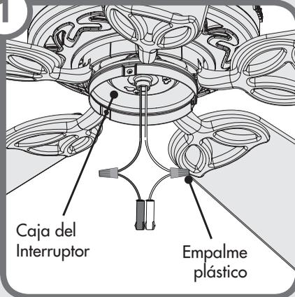
Si su ventilador no posee conectores de pines en los cables provenientes de la caja del interruptor, instale el manojó de cables proporcionado. Utilice los conectores de cables proporcionados para conectar el cable blanco del ventilador con el cable blanco del manojó de cables y conecte el cable negro o azul del ventilador con el cable negro del manojó de cables.
