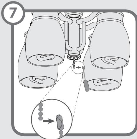
**Instalación del pendiente de cadena** - Conecte el pendiente de cadena al extremo de la cadena corta que sale de la caja del interruptor y del juego de luz.
